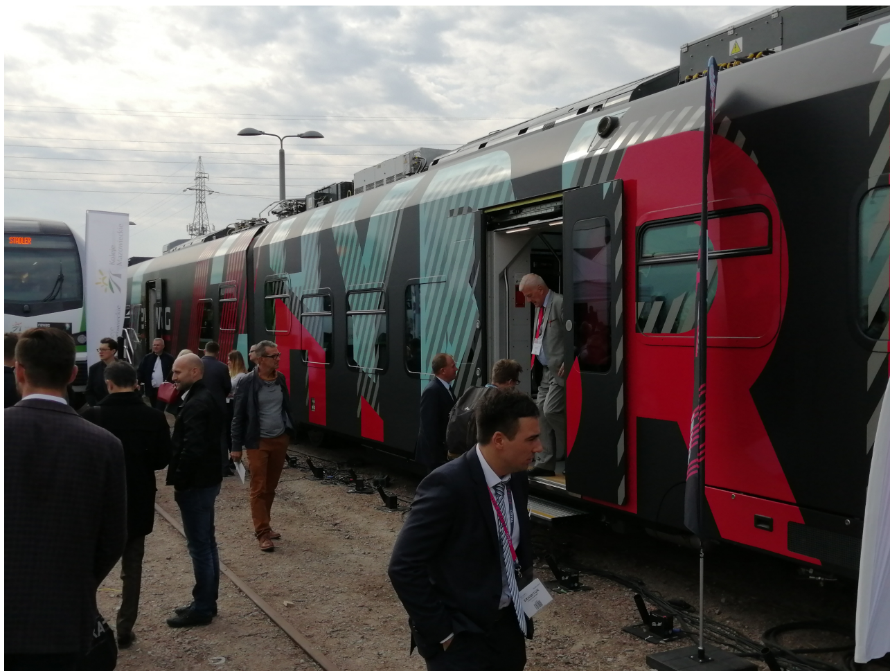
Hybrydowy skład Newagu, który może korzystać zarówno z trakcji elektrycznej jak i napędu spalinowego do jazdy po trasach niezelektryfikowanych
